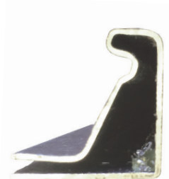
Perfiles con masilla
